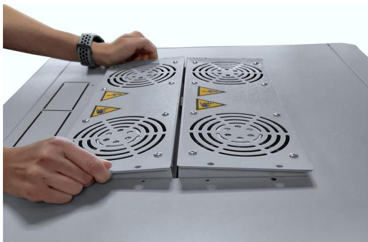
3. Приподнимите один из блоков под углом, чтобы получилась конструкция «домик» (как показано на фото). При этом блоки не должны разъединиться между собой
